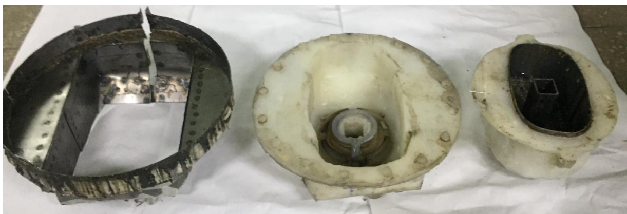
Рисунок 15 – Литейный (модельный) комплект для отливки промежуточного фонаря
