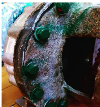
Рисунок 28 – Воздействие на внешнюю поверхность фонарного кольца после двух месяцев работы.
