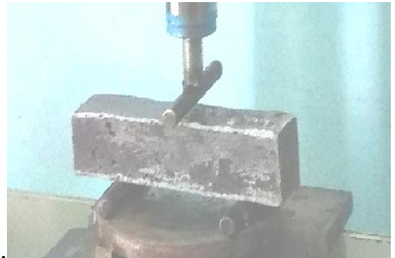
Рисунок 9 – Расчетная схема для определения предела прочности на изгиб
