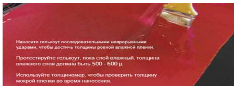
Рисунок 22 – Нанесение гелькоута кистью
