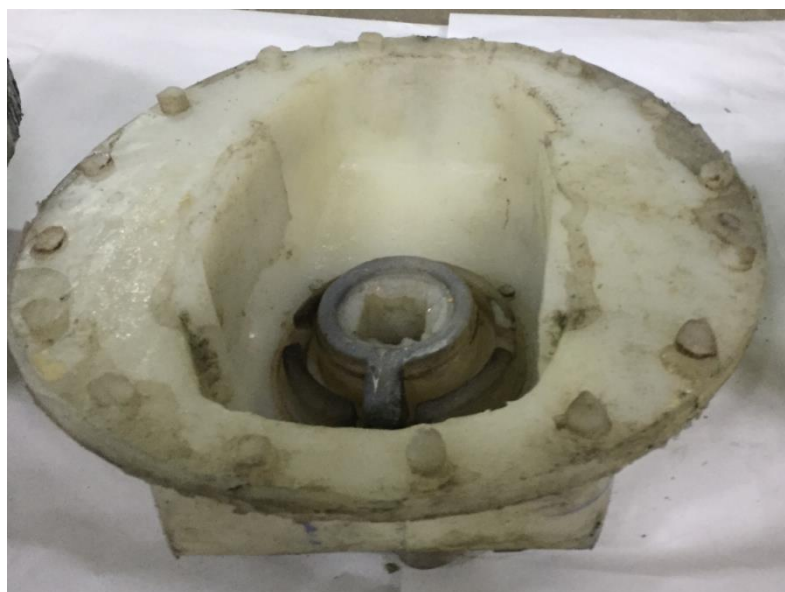
Рисунок 13 – Отливка формы внешней поверхности промежуточного фонаря из литейного силикона
