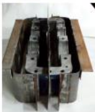
Рисунок 5 – Установка разделительной пластины в каркас основания редуктора
