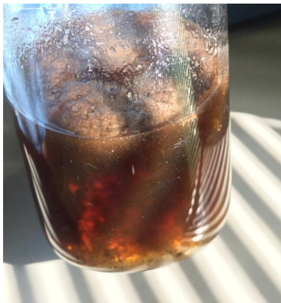
Рисунок 25 – Результат воздействия концентрированной кислоты (98%) на образцы из полимербетона
