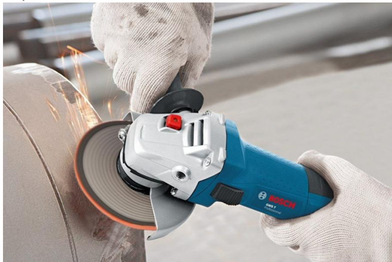
Рисунок 20 – Шлифовка поверхностей фонаря с использованием УШМ
