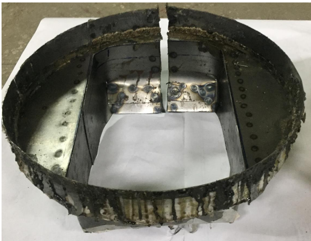
Рисунок 12 – Обечайка для формирования внешней поверхности промежуточного фонаря
