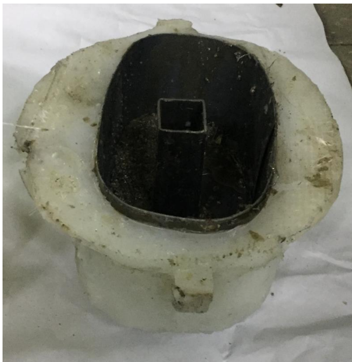
Рисунок 14 – Отливка формы внутренней поверхности промежуточного фонаря из литейного силикона
