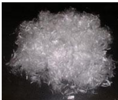
Рисунок 7 - Фибра из полипропилена
