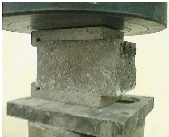
Рисунок 10 – Размещение пробников при испытании на сжатие
