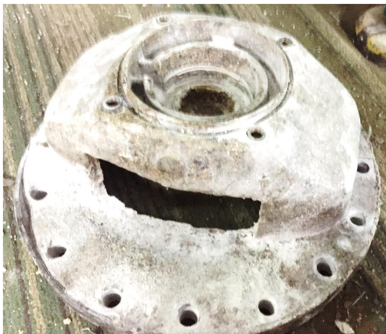
Рисунок 16 – Промежуточный фонарь, отлитый из полимербетона
