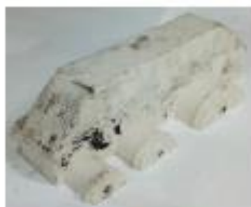
Рисунок 3 – Siliconовая модель внутренней полости корпуса редуктора
