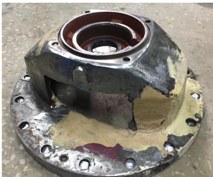
Рисунок 11 – Промежуточный фонарь горизонтального центробежного насоса, восстановленный до мастер-модели
