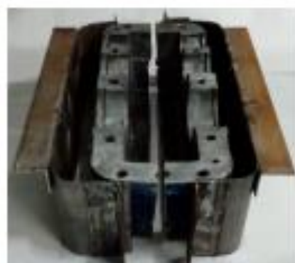
Рисунок 2 – Каркас формы крышки редуктора
