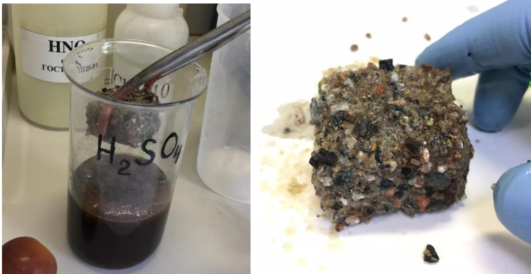
Рисунок 24 – Результат воздействия электролита на образцы из полимербетона
